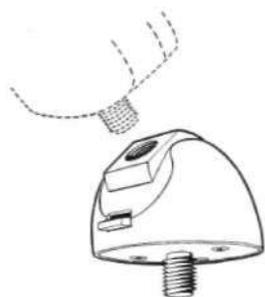
Fig. 8. Northrop-Sierra model B wrist-flexion device.
